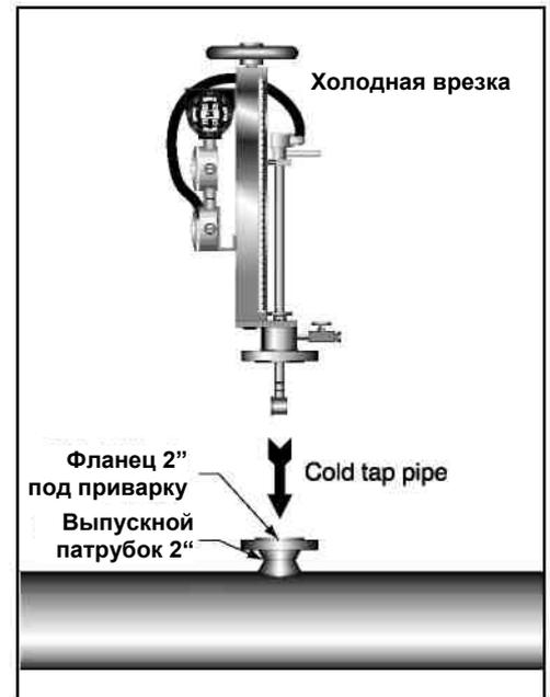
Рис.3.22. Холодная врезка V-Bar-910/960
