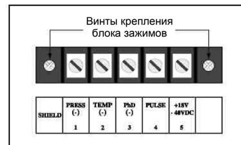
Рис.6.9. Расположение винтов крепления блока зажимов
