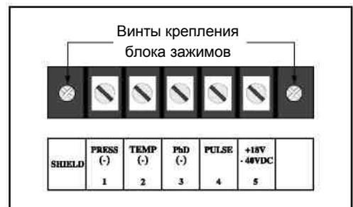
Рис.6.22. Расположение винтов крепления блока зажимов
