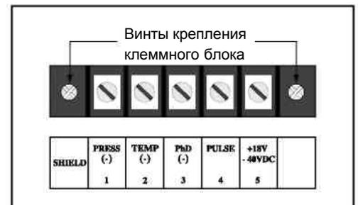
Рис.6.30. Расположение винтов крепления блока зажимов
