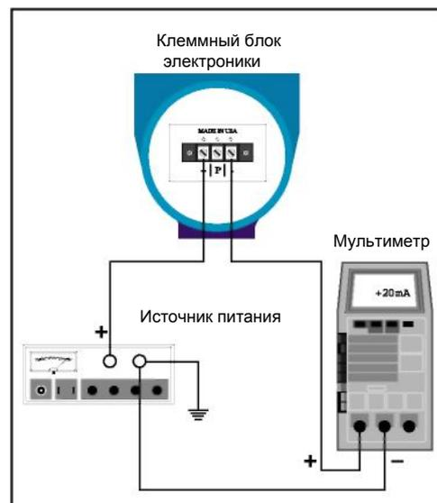
Рис.5.8. Схема соединений для калибровки выхода 4-20 мА
